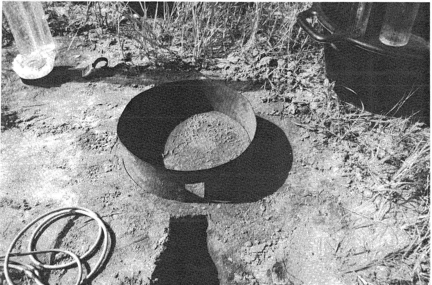
Figure 9.23. Essai pseudo-monodimensionnel : cylindre et fosse tensiométrique.
