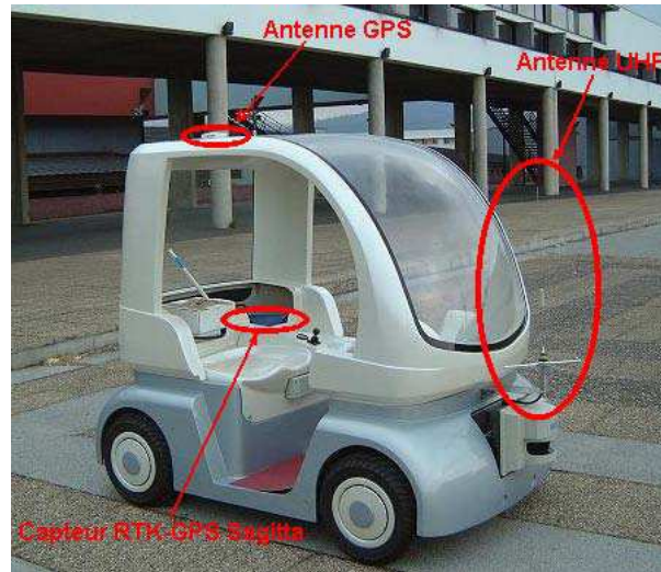
FIG. 4.5 – Implantation du capteur RTK-GPS sur Cycab
