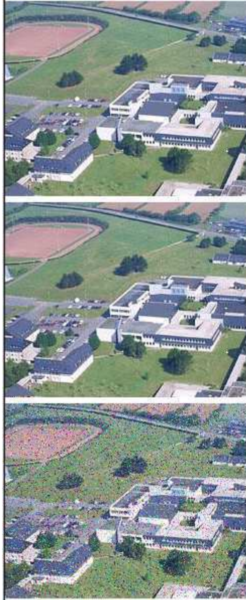
FIG. 6.13 — Décodage d'image : en haut image originale, en bas image bruitée et au milieu image après débruitage
