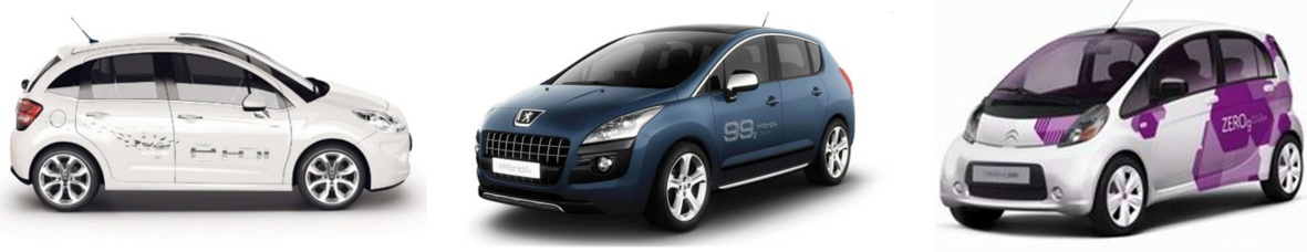
Figure 7 : Une gamme de véhicules électrifiés PSA. À gauche la micro hybride C3 e-HDI avec Stop & Start de nouvelle génération, au centre la 3008 HYbrid4 le premier full hybrid diesel et à droite la C-Zéro véhicule 100% électrique.
