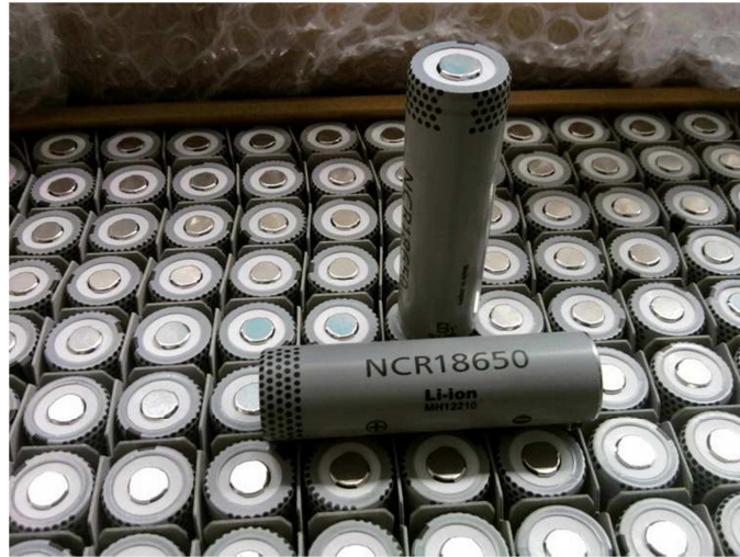
Figure 58 : Les éléments lithium-ion Panasonic NCR 18650 utilisés pour les essais.
