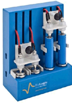
Figure 140 : Porte échantillon 18650 du LPCES pour SIE.
