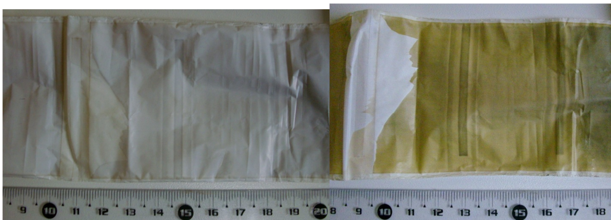
Figure 116 : Photo du séparateur de courant d'une 18650, côté blanc (à gauche) et côté jaune (à droite).
