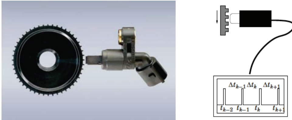
FIG. 2.2: (Gauche) Codeur incrémental basé sur une roue dentée et (droite) illustration du principe de mesure.
