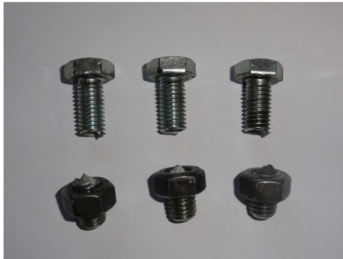
Figure 3.5.13 – Photo des boulons fracturés
