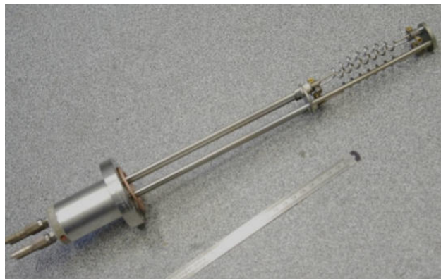
Figure 1.1 : Photo de l'élément essentiel de la pompe à sublimation à savoir le filament de titane chauffé par effet Joules jusqu'à 1300°C.
