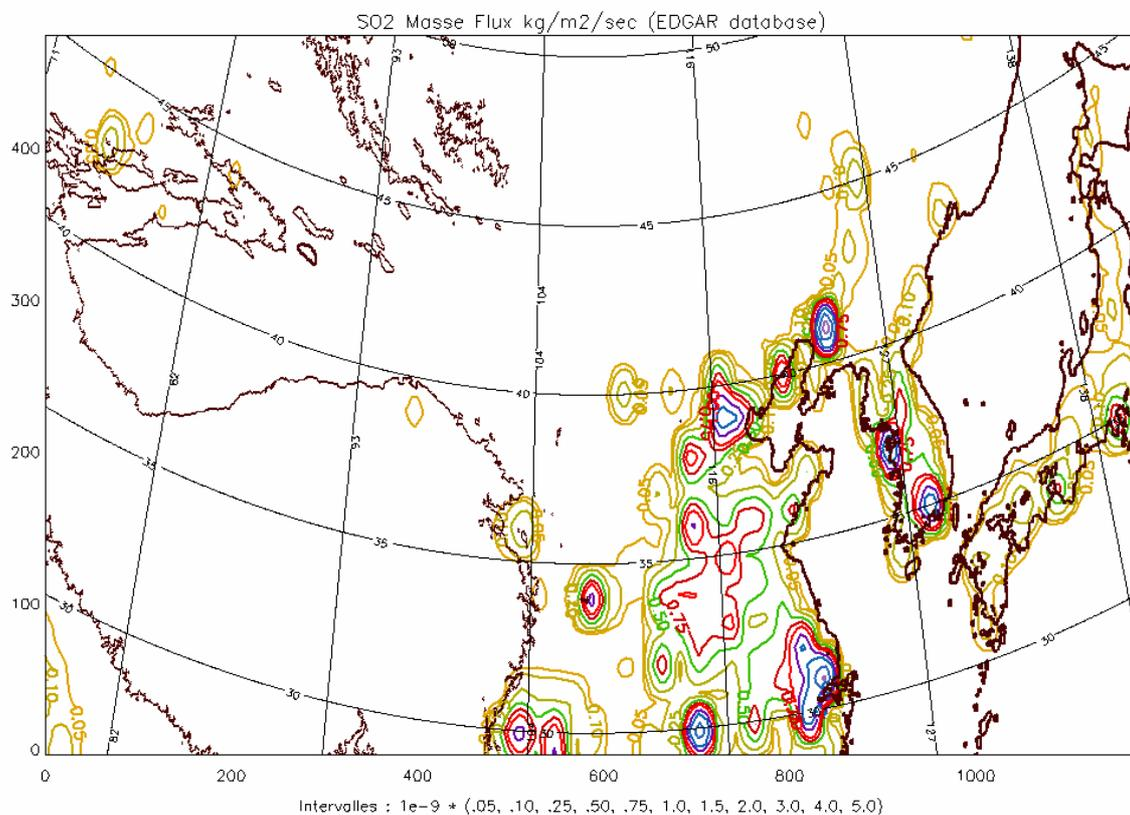
Figure 4.7.b – Isocontours des flux d'émission de  $SO_2$  d'après la base de données EDGAR. unités échelle des isocontours : de  $0,05 \cdot 10^{-9} \text{ kg} \cdot \text{m}^{-2} \cdot \text{s}^{-1}$  à  $5 \cdot 10^{-9} \text{ kg} \cdot \text{m}^{-2} \cdot \text{s}^{-1}$
