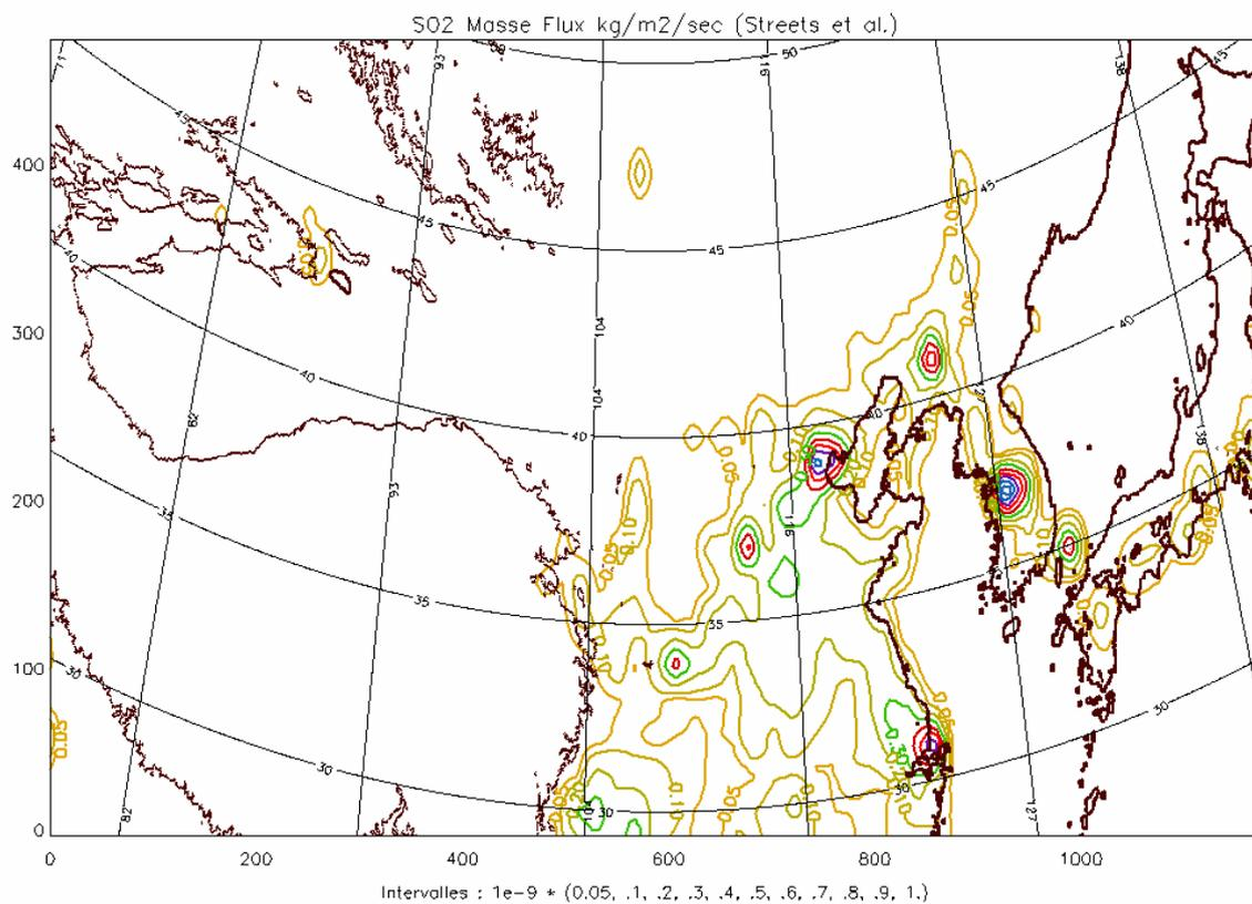
Figure 4.7.a – Isocontours des flux d'émission de  $SO_2$  d'après la base de données STREETS. échelle des isocontours : de  $0,05 \cdot 10^{-9} \text{ kg} \cdot \text{m}^{-2} \cdot \text{s}^{-1}$  à  $1 \cdot 10^{-9} \text{ kg} \cdot \text{m}^{-2} \cdot \text{s}^{-1}$
