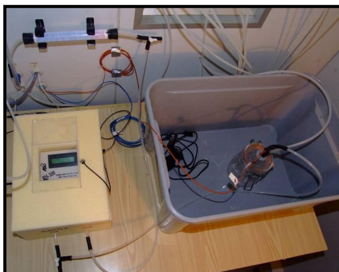
Figure 5b. Prise de vue dans le caisson à température contrôlée dans lequel les mesures sont réalisées. L'air avec une humidité connue (point de rosée = 12°C) arrive dans la chambre avec l'individu (à droite). L'air en sortie est transféré vers l'hygromètre (à gauche) qui mesure le nouveau point de rosée (« dewpoint »). L'air est ensuite séché et transféré vers les analyseurs d'O 2 et de CO 2 .
