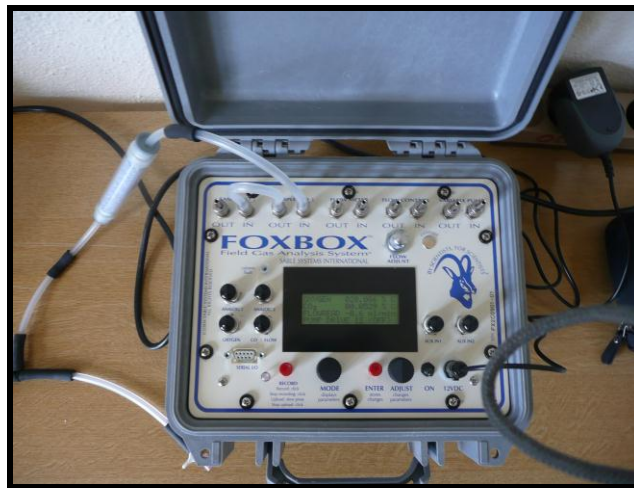
Figure 23. Matériel utilisé pour la mesure de métabolisme standard (SMR, ml O 2 /h)
