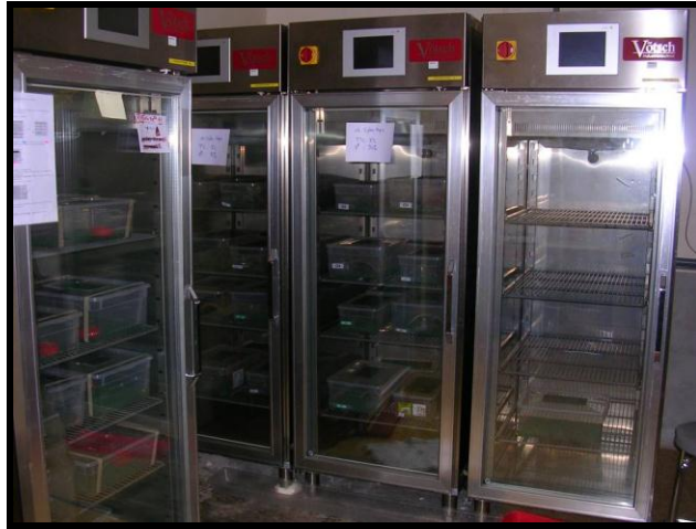
Figure 10. Enceintes climatiques permettant le contrôle des conditions thermiques et hydriques journalières
