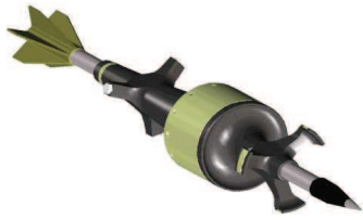
(a) Flèche maintenue par des sabots
