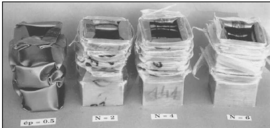
Figure III. 33 : Tubes carrés enroulés de fibre de verre [WAN 92]
