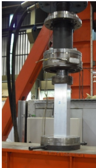
Figure III. 40 : Banc d'essai de compression sur tube
