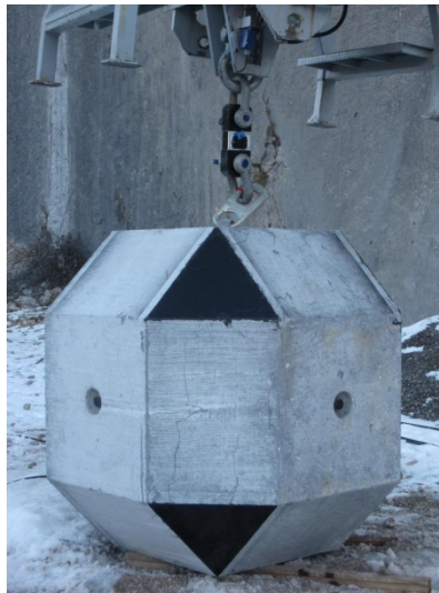
Figure IV. 15 : Bloc utilisé - Essai MEL 3000 kJ
