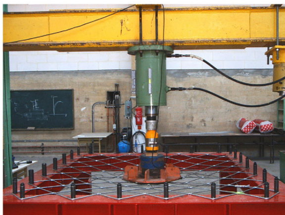
Figure I. 32 : Essai sous charge localisée, banc d'essai et comportement [CAS 08]
