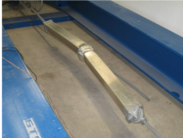
Figure III. 50 : Traction quasi-statique sur le dissipateur
