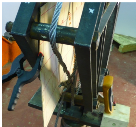
Figure II. 18 : Torsion dans les câbles de bord
