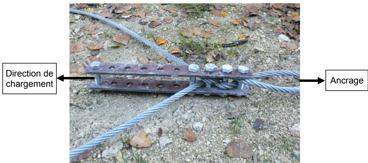
Figure III. 6 : Principe du dissipateur 2 par frottement
