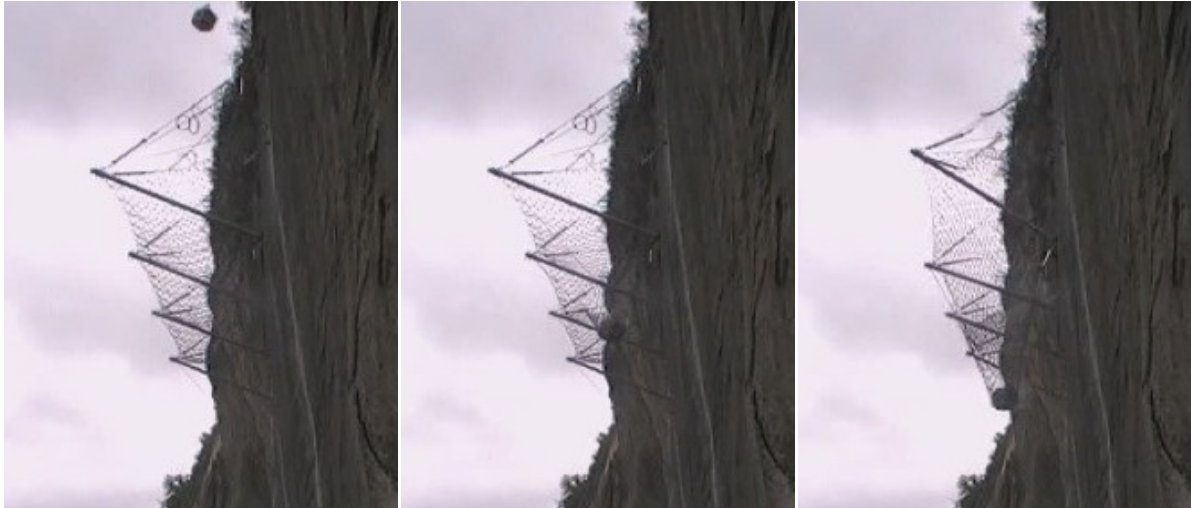
Figure IV. 30 : Trajectoire et preuve de non contact du bloc lors de l'impact – Essai SEL 3000 kJ
