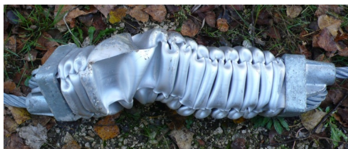
Figure III. 59 : Etat du dissipateur en ALU 100×100×4 après l'essai. Energie absorbée = 196 kJ, vitesse d'impact = 15,4 m/s
