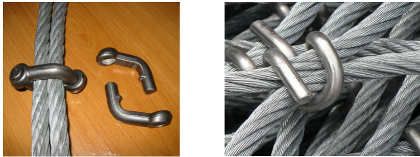
Figure I. 19 : Agrafe rigide (à gauche) et fusible (à droite)
