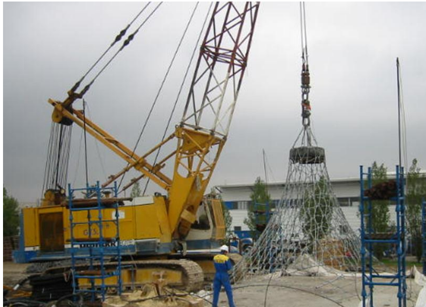
Figure I. 33 : Essai de traction sur le filet de GTS
