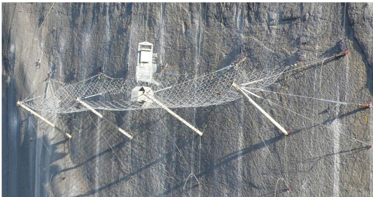
Figure IV. 39 : Vue générale de l'écran avec le bloc en position de référence – Essai 2 MEL 5000 kJ
