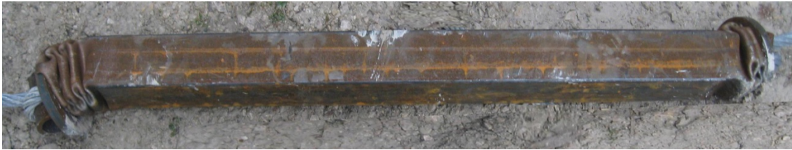
Figure III. 57 : Etat du dissipateur en acier S235 80×80×2 après l'essai. Energie absorbée = 88 kJ, vitesse d'impact = 13,1 m/s
