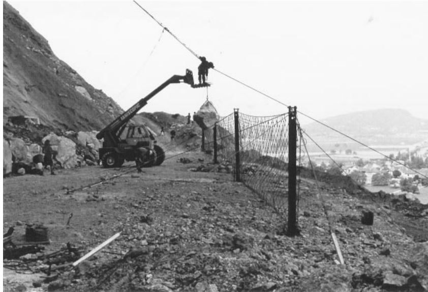
Figure I. 43 : Vue globale du site d'essais et de l'écran testé, [PEI 98]
