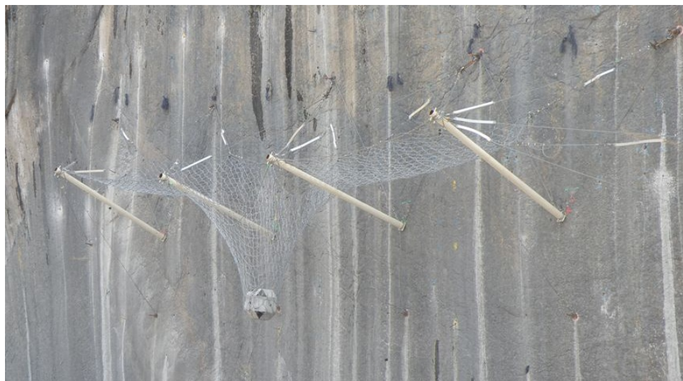
Figure IV. 58 : Retenu du bloc après le deuxième lâcher du bloc – essai SEL 5000 kJ
