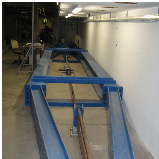
Figure III. 1 : Banc d'essais de traction en quasi-statique
