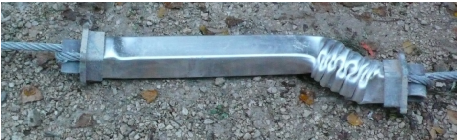
Figure III. 63 : Etat du dissipateur en tube ALU 100×100×5 après l'essai. Energie absorbée = 220 kJ, vitesse d'impact = 16,3 m/s
