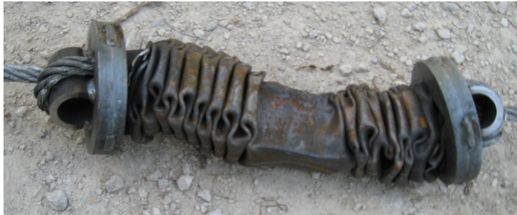
Figure III. 55 : Etat du dissipateur en acier S235 80×80×2 après l'essai, Energie absorbée = 257 kJ, vitesse d'impact = 17,7 m/s
