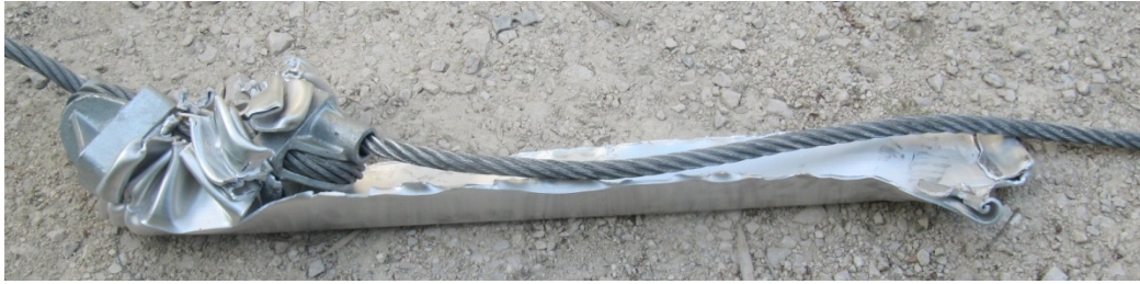
Figure IV. 40 : Déchirure typique d'un dissipateur avec un tube ALU du lot 2 – Essai 1 MEL 5000 kJ
