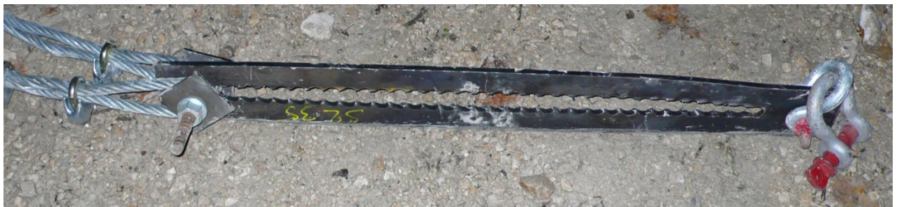
Figure III. 22 : Frein ABS après l'essai
