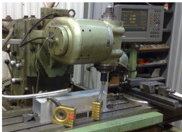
Figure III. 41 : Surfaçage des faces du tube
