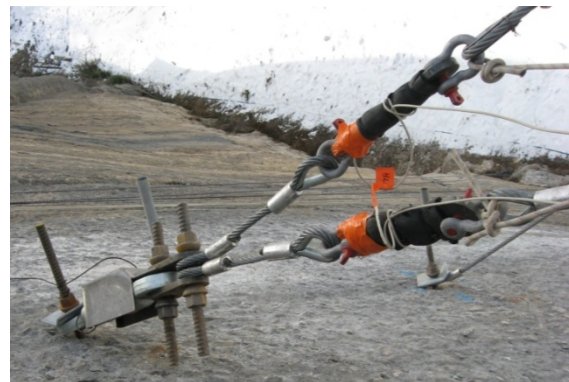
Figure IV. 9 : Capteurs de force locaux
