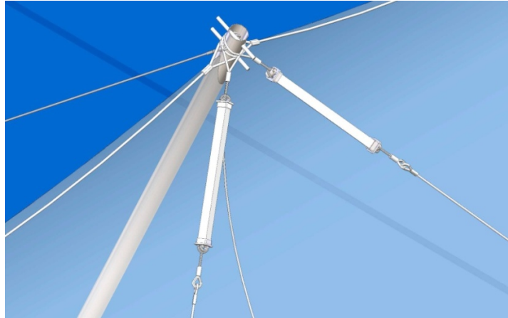
Figure IV. 4 : Détail de l'assemblage en tête de poteau
