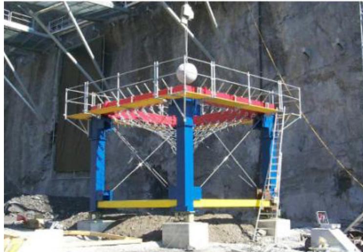
Figure I. 36 : Dispositif d'essais dynamiques sur filets [EDO 02]
