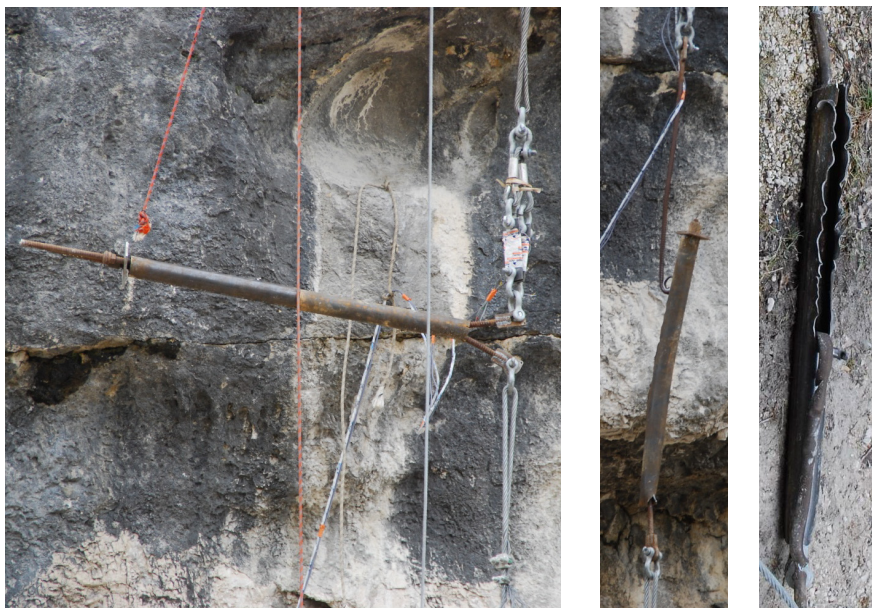
Figure III. 13 : Dissipateur par déchirure
