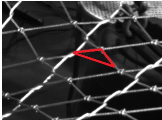
Figure II. 9 : Angle d'ouverture d'une agrafe
