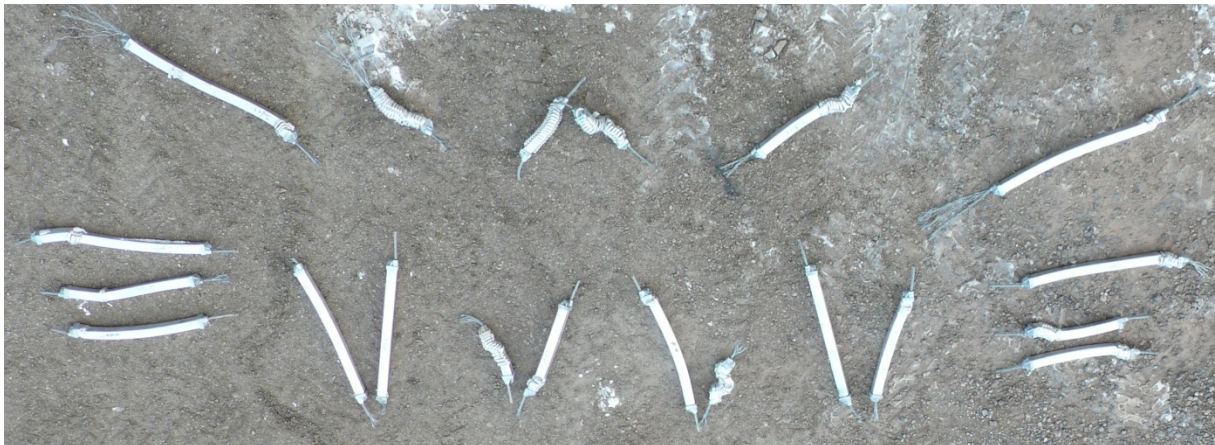
Figure IV. 56 : Etat des freins après l'essai – essai SEL 2 5000 kJ
