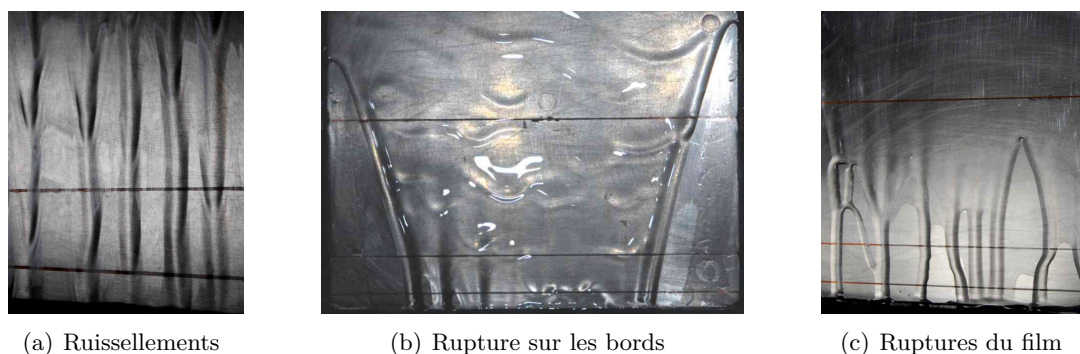
FIGURE 5.21 – Évolution de la structure de l'écoulement du film s'écoulant librement sur la paroi avec une augmentation du flux thermique pariétal [61]
