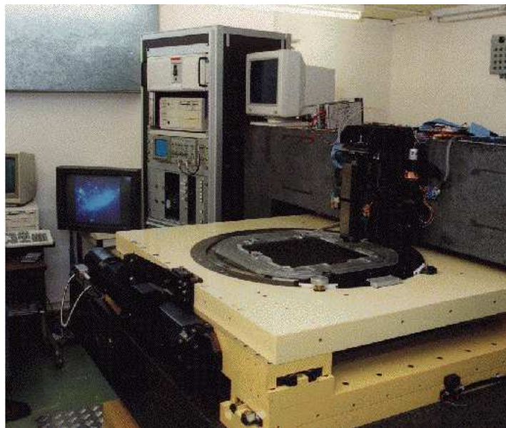
Figure 3.4 – Machine Automatique à Mesurer pour l'Astronomie (MAMA).
