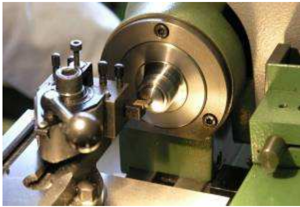
Figure III-27 : L'usinage du barreau de composite
