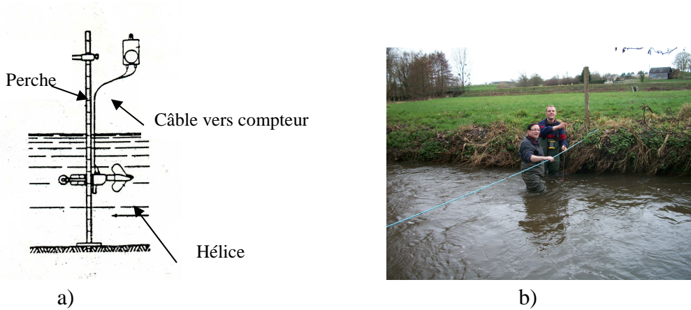
Figure 8.3: a) Le moulinet hydrométrique ; b) Mesure du débit sur l’Oir
