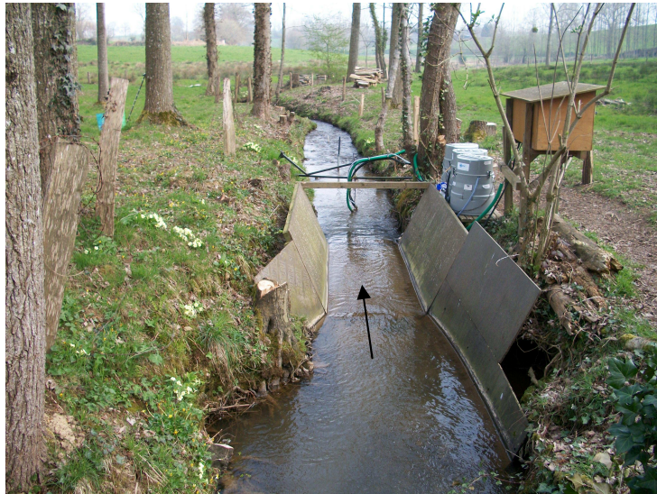
Figure 2.9 : Station de mesure du débit et de la turbidité sur le Moulinet (Février 2011).
