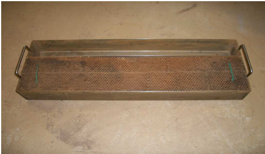
Figure 3.1 : Dispositif de mesure du charriage en fond de rivière
