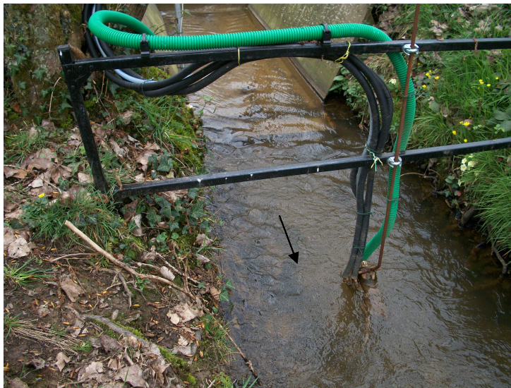
Figure. 2.10 : Fixation du turbidimètre sur le Moulinet
