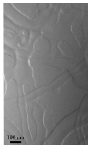
(c) L= 5 cm, tension de 18 kV, température = 120 °C, taux d'écoulement = 5 \mu l/s
