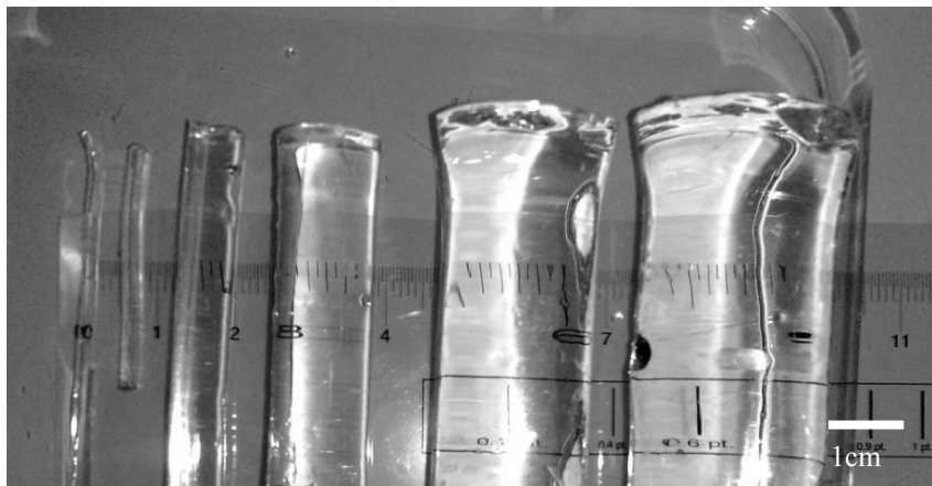
Figure 3: Photographies des gels cylindriques en PAAM de différents diamètres avant hydratation.
