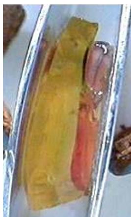
Figure 13. Fracture de l'hydrogel au niveau de l'interface acide – base.
