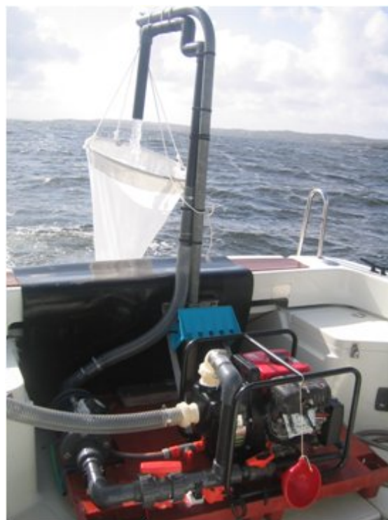
FIGURE 3.3 – Photographie du dispositif de pêche de larves par pompage ©Ifremer 2008.
