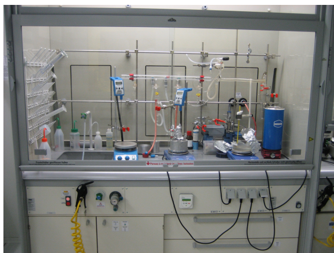
FIGURE III.1 – Image de la rampe à vide.
