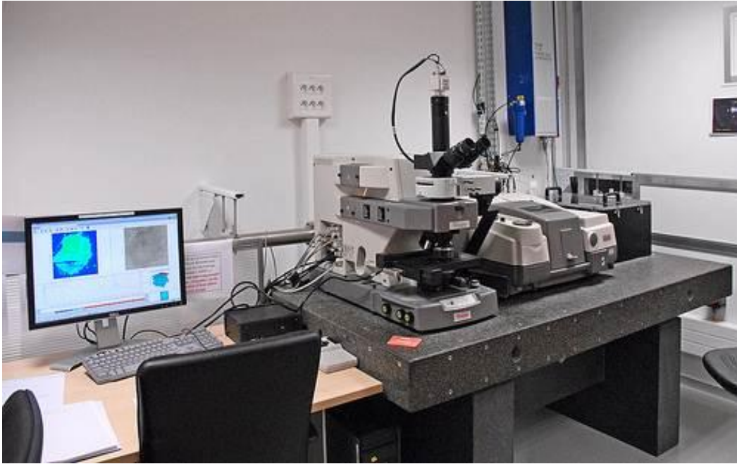
Figure 66 : Vue générale du spectromètre moyen infrarouge sur la ligne SMIS du synchrotron SOLEIL.
