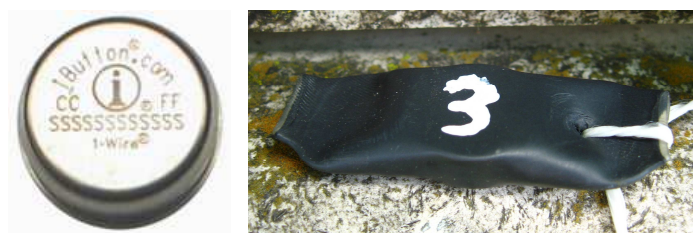
Figure 2 : iButton thermochron. Dimensions : 17mm de diamètre x 6 mm de haut. Poids : 4g. Précision : 0.5°C. Températures limites : -10 à +85°C. Chaque logger était entouré d'une gaine thermorétractable pour le protéger de l'humidité.
