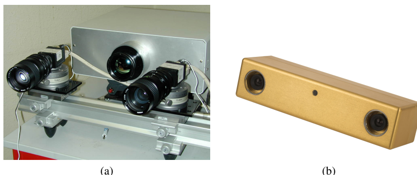
FIGURE 2.2 – (a) Configuration stéréo canonique sur notre système stéréo du prototype PICASSO (Plateforme d'Intégration de CApteurs multi-Sen$Oriels), avec deux caméras dans le visible entourant une caméra thermique, (b) Système de stéréovision Bumble Bee2 fabriqué par Point Grey Research©.
