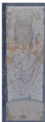
Figure E-16 : Macrographies des faciès de rupture - éprouvette CT testée à -75^{\circ}\text{C}
