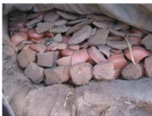
Fig. 3. Céramiques placées à l'étage du four, avant cuisson.
