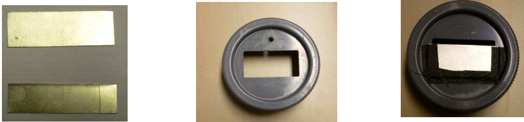
Figure 4.12 : Photographie des plaques en acier, bouchon avec trou et bouchon avec une légère ouverture obtenue à l'aide des plaques en acier.
