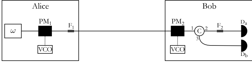
FIG. 2.8 : Schéma de principe du protocole BB84 en fréquence réalisé à l'aide de modulateurs de phase (PM) alimentés par une tension oscillante à une radiofréquence \delta . ( F_1 : filtre transmettant \omega et \omega + \delta ; F_2 : filtre réfléchissant seulement \omega ; C : circulateur optique fibré).
