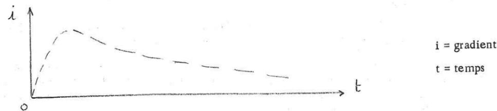
De 0 il va commencer par augmenter rapidement tant que le niveau de l'eau monte dans la rivière ; ensuite il va baisser lentement au fur et à mesure que le niveau de la nappe tend vers l'équilibre. La valeur maximale atteinte pour une crue de 2 mètres est de 2/10 (10 mètres = largeur de la digue).
