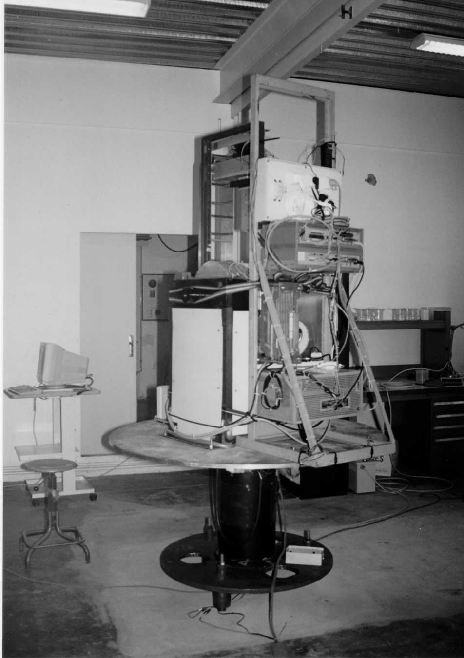
FIG. 2.3 – Photo de notre expérience installée sur la table tournante du Laboratoire des Ecoulements Géophysiques et Industriels de Grenoble (LEGI). L'électro-aimant est fixé au centre de la table de 1.5 mètre de diamètre. Le support vertical, où se trouve l'essentiel de l'électronique, est arrimé à l'électro-aimant avec une sangle. L'unité centrale du PC (à gauche) pilote l'expérience en étant embarquée sur la table pendant la rotation.
