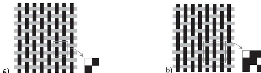
Figure 2.2 : Structures d'un textile : (a) toile, (b) sergé.
