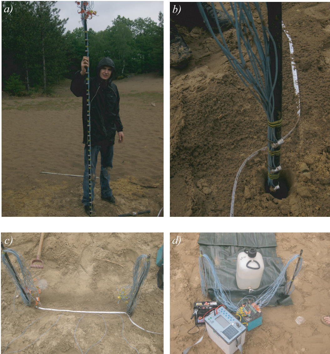
FIGURE IV.1 – Mise en place du dispositif de mesures développé pour les tests de terrain préliminaires. a) Le système de mesures est constitué de deux perches ayant 21 électrodes espacées de 10 cm. b) Chaque perche est enfouie verticalement dans une zone sableuse tabulaire dont l'épaisseur minimale est estimée à 3 m. c) Un fossé de 10 cm de profondeur est creusé entre les deux puits distants de 90 cm et 5 électrodes de surface espacées de 15 cm sont ajoutées dans le fossé. d) Le creux est recouvert d'un tissu perméable puis rempli par un traceur contenant 1,2 \text{ g.L}^{-1} de \text{NaCl} à \rho_f = 4,3 \Omega.m . L'acquisition des données est réalisée automatiquement par une centrale d'acquisition.
