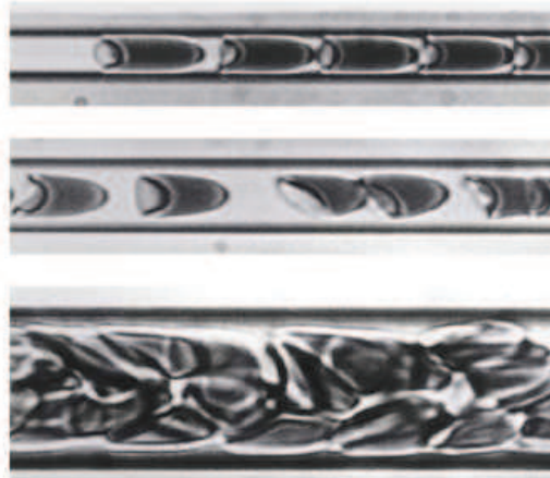
Figure 53 : Ecoulements des globules rouges humain dans des tubes de diamètres 4 , 7 et 17 \mu\text{m} de haut en bas respectivement. (d'après Handbook of Physiology – Microcirculation (2002))
