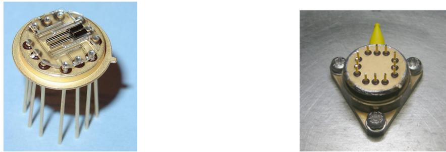
FIG. 1.23 – A gauche : Le VIG sur son embase. A droite : Le boîtier cuivre queusoté.
