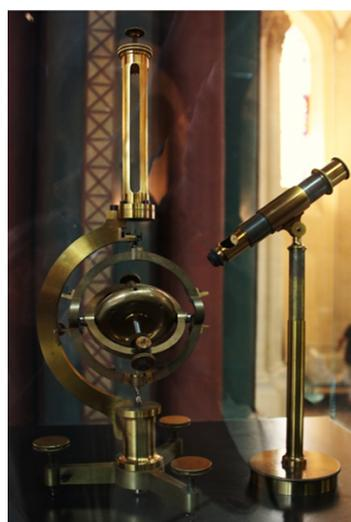
FIG. 1.1 – A gauche : L'appareil de Bohnenberger (exemplaire du lycée Fabert de Metz). A droite : Le gyroscope de Foucault (Conservatoire National des Arts et Métiers)
