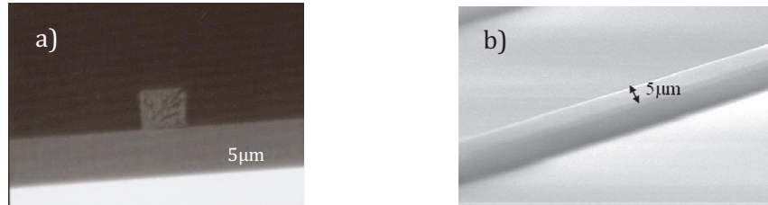
Figure 84 : Guide droit pour un séchage de 20 minutes à 80°C; a) au microscope optique; b) au MEB
