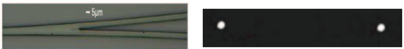
Figure 85 : a) Vue au microscope optique d'un diviseur par 2; b) Sortie du diviseur pour \lambda=1,31\mu\text{m}
