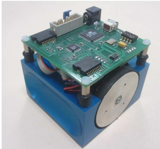
FIGURE 4.19 – Miabot, petit robot à deux roues produit par Merlin Robotics.
