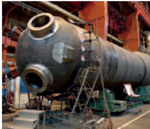
FIGURE B.2: Générateur de vapeur en cours de fabrication (GENET 2010).
