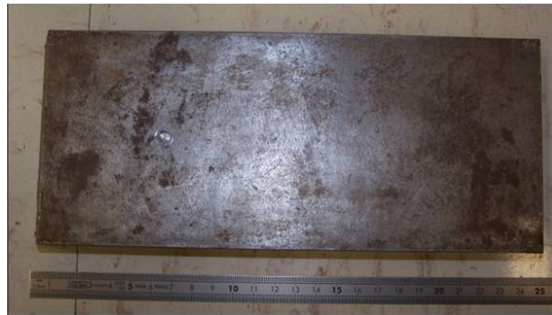
FIGURE 3.44: Photographie de la plaque d'acier 16MND5 utilisée dans cette étude.
