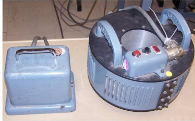
FIGURE 3.45: Photographie de l'appareil utilisé pour démagnétiser la plaque.
