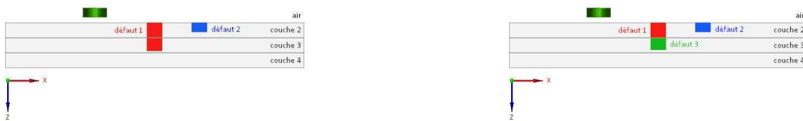
FIGURE 4.6: Séparation du défaut traversant les deux couches en deux défauts différents, les défauts 1 et 3, en correspondance de la frontière entre les deux couches.
