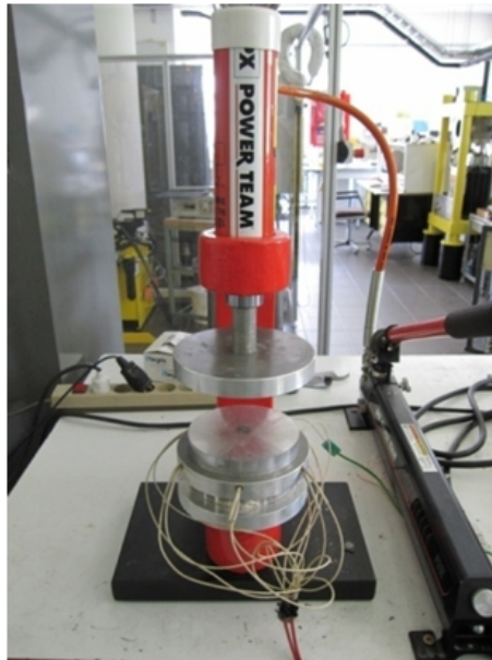
Figure 10 : Photographie de la presse uniaxiale à plateau chauffant utilisée pour assembler deux substrats métalliques étamés
