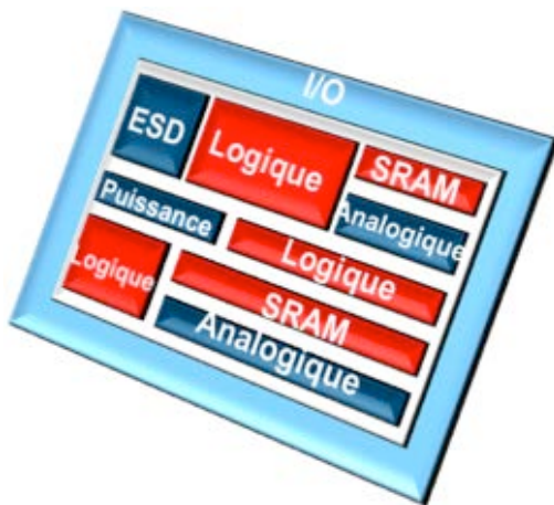
Figure II.54 : Exemple d'une puce utilisant une technologie hybride. Le BULK (bleu) serait conservé pour les applications analogiques, I/O, RF, puissance etc... Une technologie UTBB (LSOI, FDSOI) serait utilisée pour les parties logiques et SRAM.
