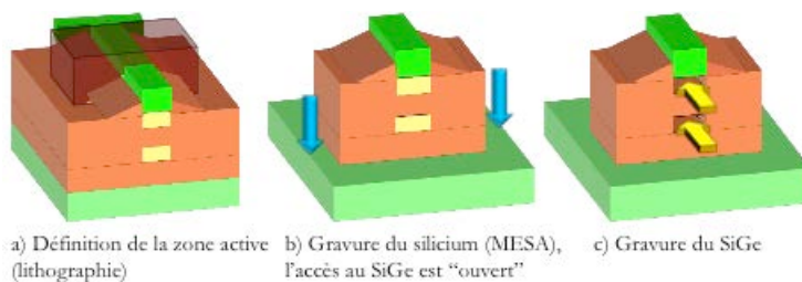
Figure IV.24 : schéma d'intégration détaillant l'étape de gravure de la zone active donnant accès aux couches de SiGe.
