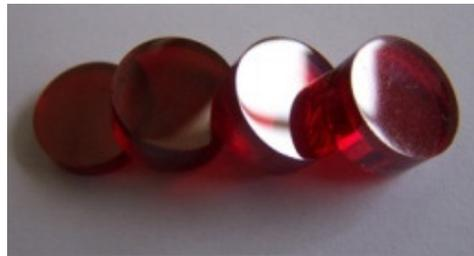
Figure V.3 : Échantillons en  $As_2S_3$  polis, à faces parallèles.
