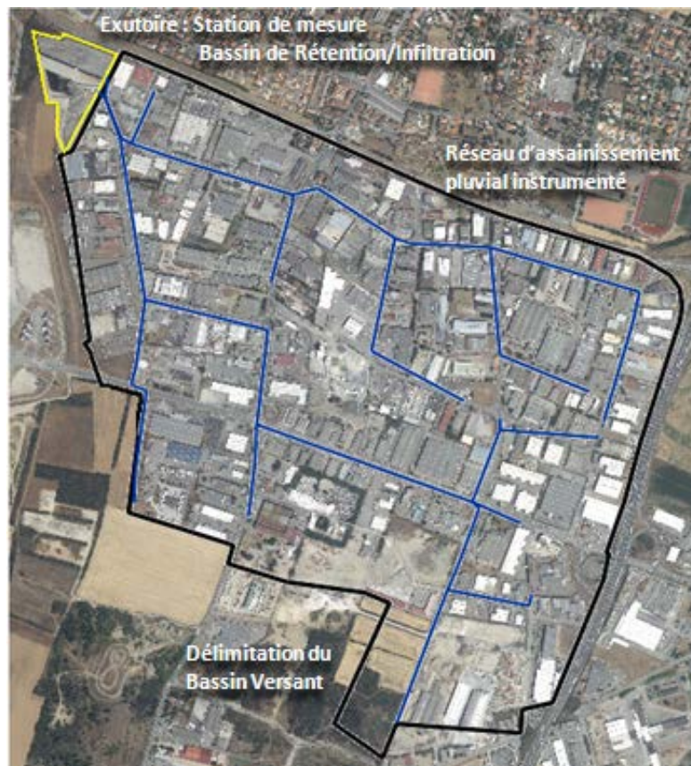
Figure 2.2: Présentation du bassin versant de Chassieu (Photo : Grand Lyon ; géo-référence du réseau d'assainissement : Canoe)
