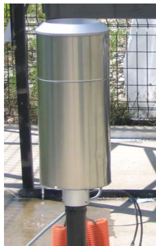
Figure 2.5: pluviographe PLUVIO OTT, installé sur les sites OTHU
