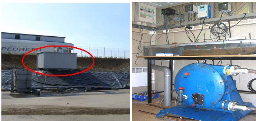
Figure 2.8 : Bungalow type OTHU (à gauche) et canal expérimental alimenté par une pompe péristaltique (à droite)
