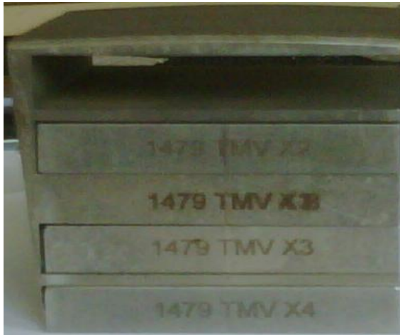
Matériau TMV : 4 échantillons (X1 à X4) Dimensions 60 x 60 x ép. 10 mm
