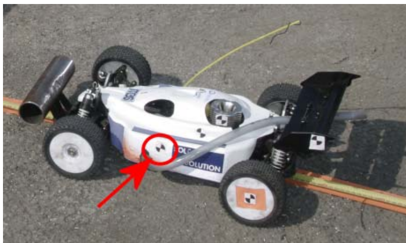
Figure 98. Cible retenue pour la mesure des coordonnées X / Y.
