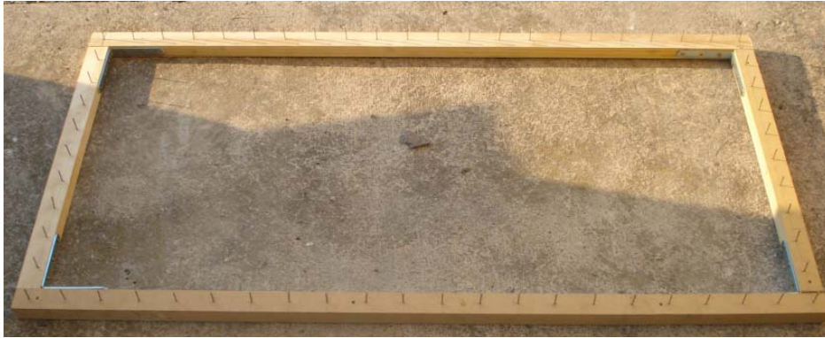
Figure 86. Cadre tendeur de nappe.
