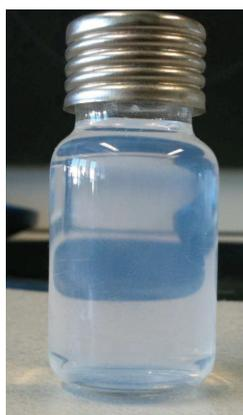
FIGURE 1.24 – Solution de nanocristaux de *KTP* synthétisés en suspension dans l'eau.
