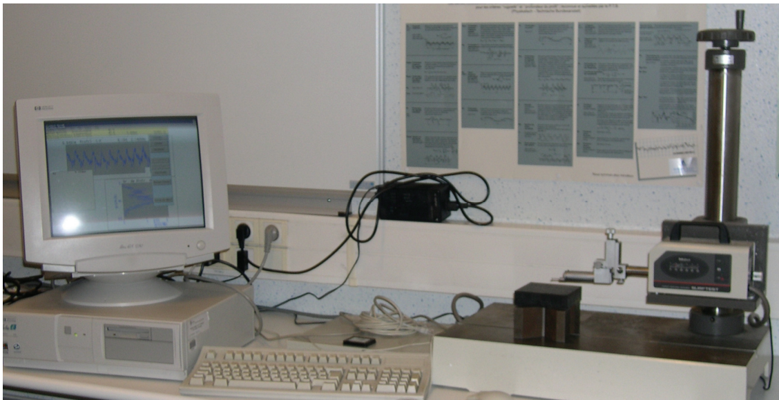
Figure 2-16: rugosimètre Mitutoyo Surftest SV500
