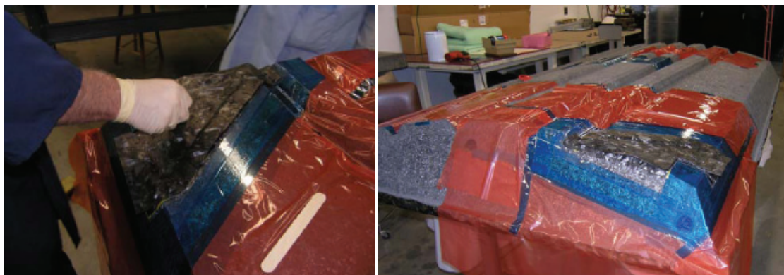
Figure 1-15: réparation d'un moule en Hextool™
