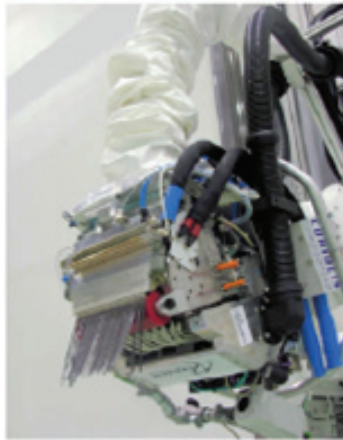
Figure 1-5: procédé de placement de fibre
