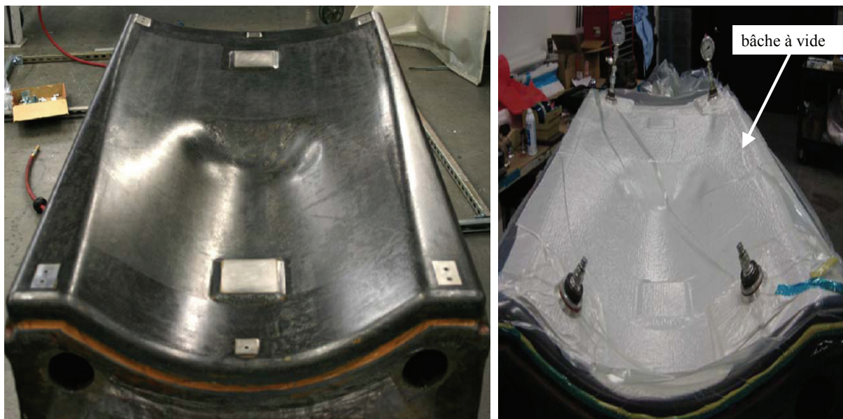
Figure 1-13: moule en Hextool™ pour RTM-Light (société NovaTech)
