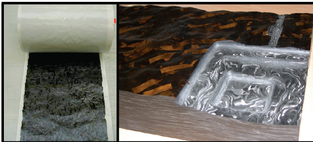
Figure 1-11: Hextool™ sous forme de préimprégnés et usiné
