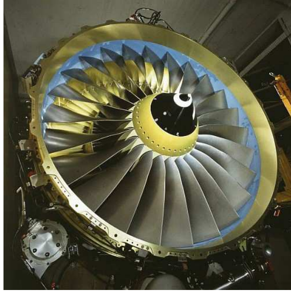
FIG. 4.4: Turboréacteur CFM56. La soufflante possède un angle \beta important en pied de pale qui diminue à mesure que l'on s'éloigne du moyeu, conformément à l'explication fournie figure 4.3 (publié avec la permission de Snecma, groupe SAFRAN).
