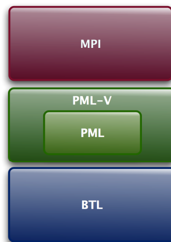
FIGURE 4.10 – Architecture d'OpenMPI-V : placement du PML Vampire dans la pile de communications MPI
