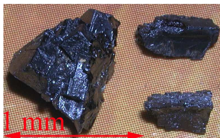
FIGURE 3.12 – Image de monocristaux isolés par chauffage du flux solidifié dans l'acide nitrique
