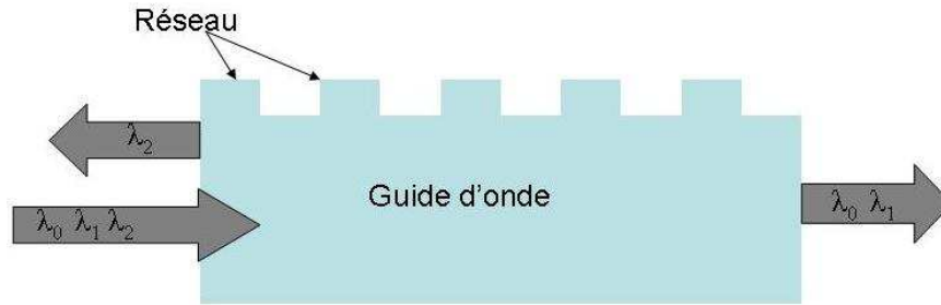
Figure 1.13 Schéma de principe d'un filtre résonnant à modes guidés
