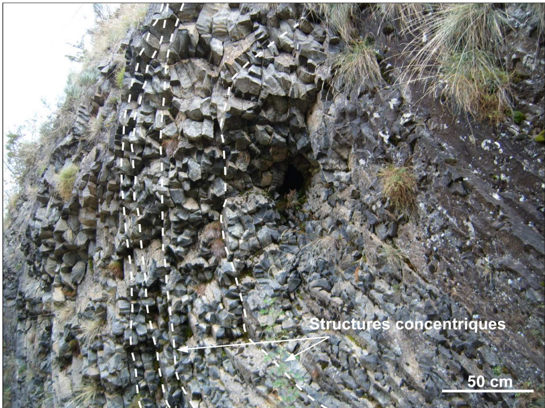
Figure 2-10 : Structures concentriques observées dans l'entablement, La Palisse barrage.
