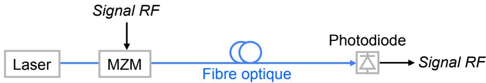
FIGURE I.1 – Exemple de liaison opto-hyperfréquence pour le transport des signaux RF. MZM désigne le modulateur d'amplitude (usuellement on utilise un Modulateur de Mach-Zehnder (MZM)). Dans la suite de ce manuscrit, nous utiliserons la convention suivante : les liaisons optiques seront en bleu, les liaisons électriques en noir.
