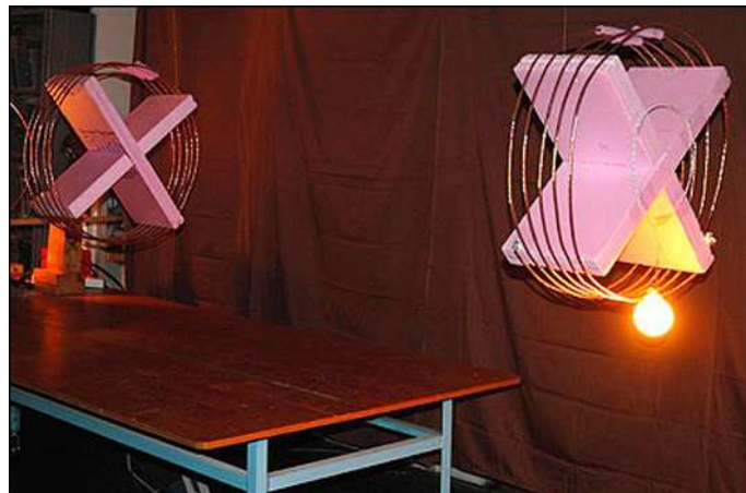
Fig. 1 : Expérience de transfert inductif d'énergie menée au MIT en 2008
