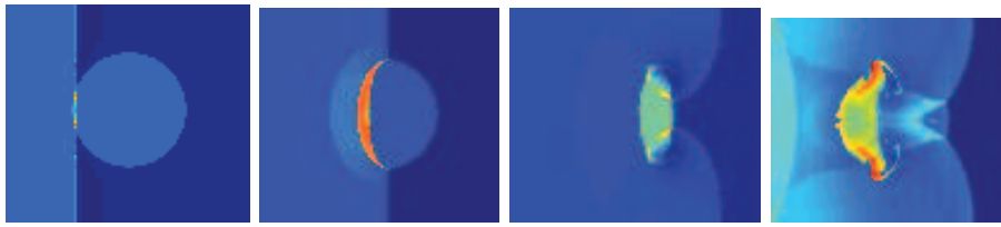
FIG. 1.11 – De gauche à droite : une fibre avant, pendant et après le passage du choc.
